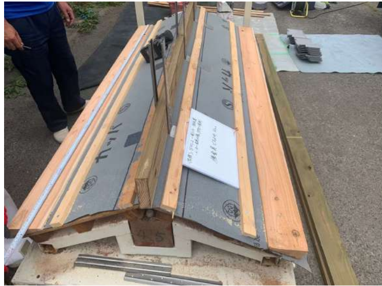
第三架台簡易箱棟工法スワロー仕様 2
