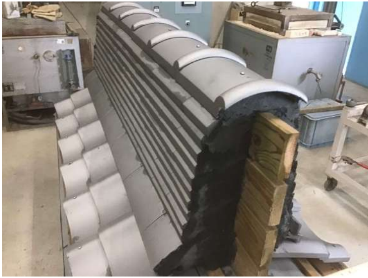
第三架台簡易箱棟工法スワロー仕様7
